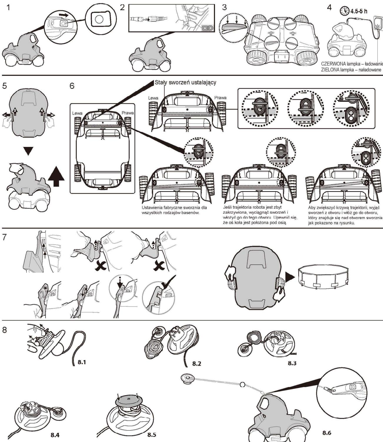
**Uwaga:** Podważyć, aby odłączyć pokrywę pływaka, zwolnić linię z pływaka do głębokości wody basenowej plus około 0,5 m (19,7").
