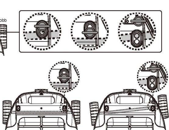
Ha a robot pályája túlságosan nagy görbét ír le, húzza ki a csapot, és helyezze ebbé a furatba. Bizonyosodjon meg arról, hogy a keréktengely a tengely alatt található.
