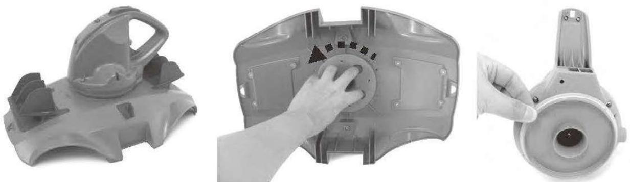
2. Använd skruvmejseln för att skruva loss de fyra skruvorna på undersidan av huvudet för att lossa bottenplattan först. Använd skruvmejseln för att skruva loss alla skruvar på basen enligt bilden. Ta bort impellern och bänd sedan upp basen och ta bort den för att exponera huvudet inuti.
