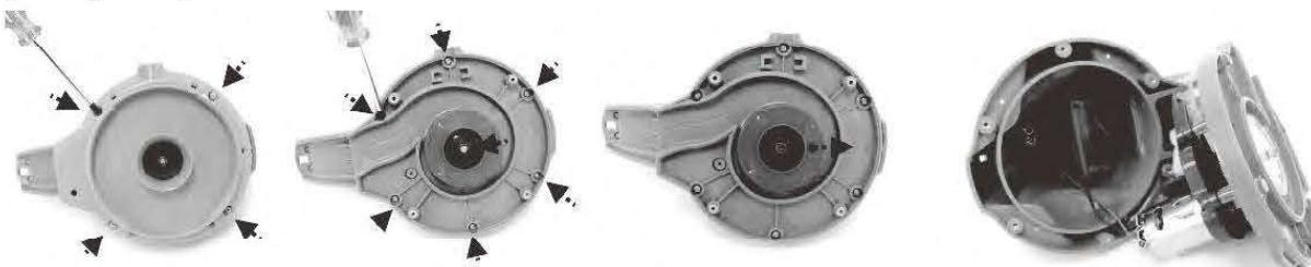
3. Wymontować pakiet akumulatorowy, aby odsłonić PCBA. Aby odłączyć przewód łączący akumulator, nacisnąć zacisk na złączu, a następnie wyciągnąć go. **UWAGA:** Natychmiast owinać złącze taśmą izolacyjną z celu uniknięcia zwarcia spowodowanego przez kontakt między obiema końcówkami przewodów.
